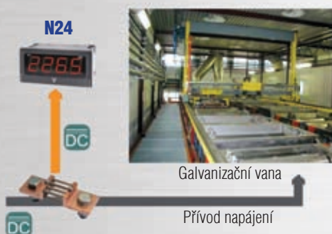
Měření proudu v galvanizovně
